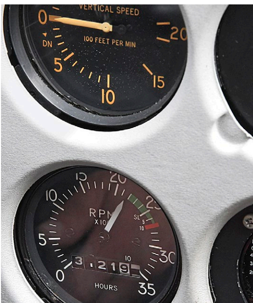
Reise-Drehzahlen am unteren Rand des grünen Bogens drücken den Mogas-Verbrauch.
